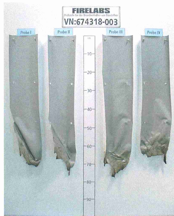
Bild 6 Aussehen des Probekörpers nach dem Brandversuch
