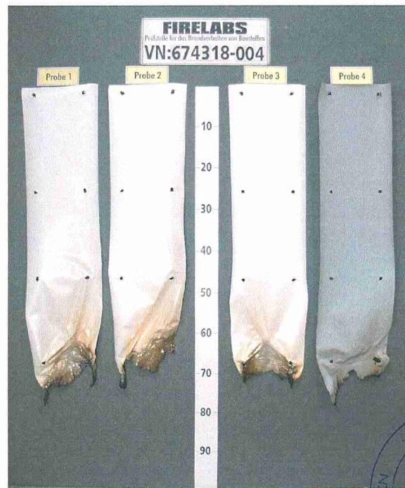
Bild 8 Aussehen des Probekörpers nach dem Brandversuch (Probe 4: Rückseite)
